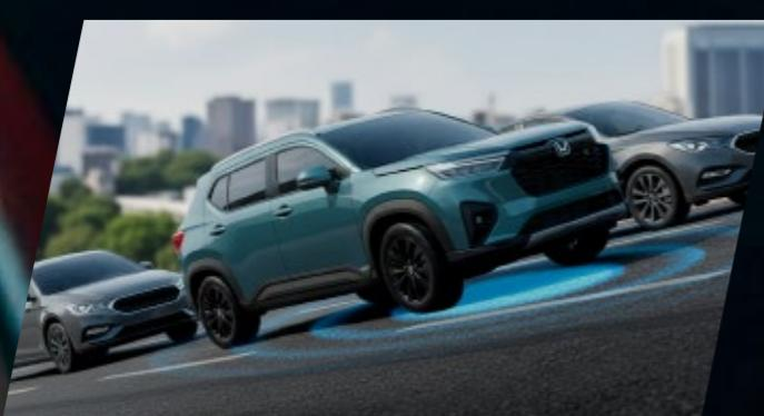
**El HSA (Hill Start Assist)** mantiene el freno accionado durante unos segundos después de soltar el pedal del freno, proporcionando más seguridad al arrancar en pendientes.
